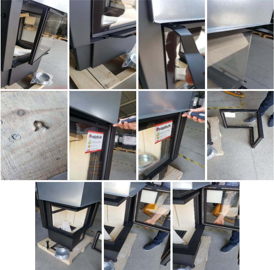
**Punkt 2.** Stellen Sie Kamineinsatz bei der Schornsteinachse und Regulieren Sie die Stellfüße mit ein Schlüssel 24. Der Kamineinsatz muss auf die Höhe von 405mm Unterkante Zarge Rahmen ausgerichtet werden. Jetzt müssen Sie die Silbersicherungsmutter von Schrauben lösen.
